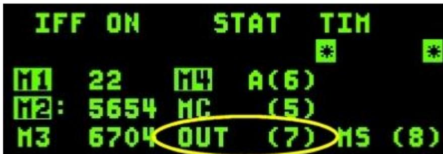
L'appui du bouton ENTR du ICP modifiera la réponse du Mode 4 de l'IFF entre les différentes options qui sont :
