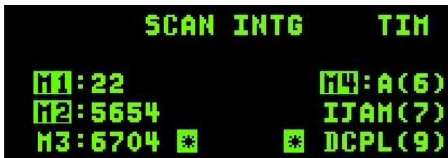
Vous pouvez sélectionner différents Modes et Codes Actifs pour les 2 pages. Ces paramètres seront sauvegardés, permettant au pilote d'avoir différent schéma d'interrogation pour les 2 modes (SCAN et LOS).
