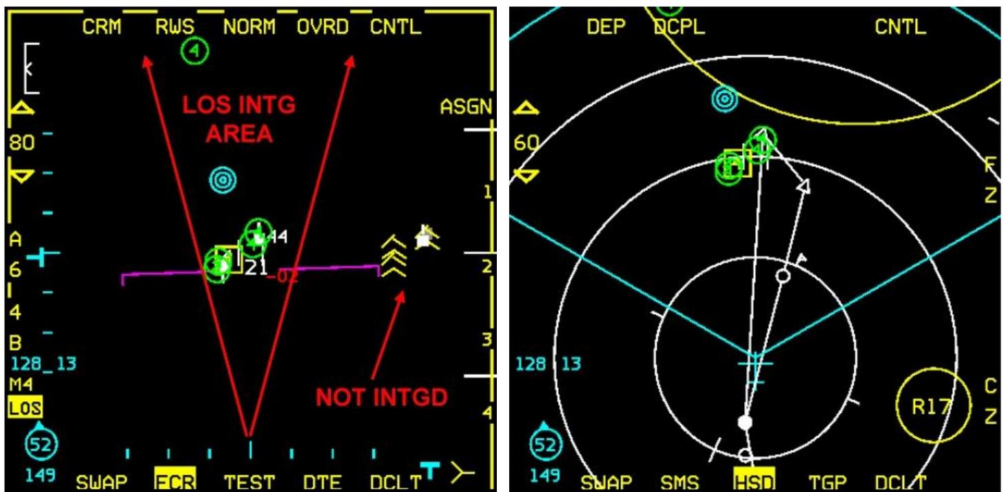
Comme nous pouvons le voir sur les images ci-dessus, les contacts en brouillage radar ne sont pas interrogés cette fois puisqu'ils sont environ 15° à l'extérieur du cône d'interrogation du curseur d'acquisition. D'un autre côté, notez la réponse du contact allié en Mode4 à 80mn. Celui-ci est à l'intérieur du cône d'interrogation et fournit une réponse valide puisqu'il s'agit d'un allié.
